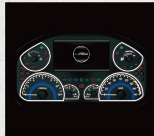
监测系统内装仪表盘 7inch LCD Display / 监控车辆实时行驶信息
